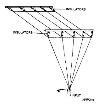
Figure 2-24.—Vertical fan antenna.
